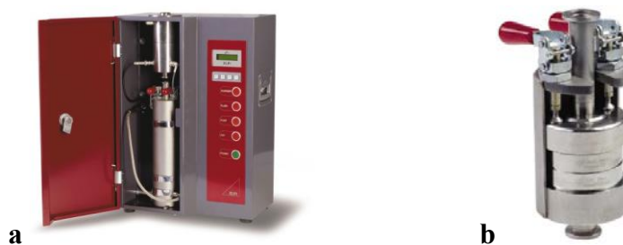
Figure 2-15 : Impacteur Electrique Basse Pression ( ELPI , a, image issue du mode d'emploi) et Impacteur Manuel (IM, b, image issue du mode d'emploi)
