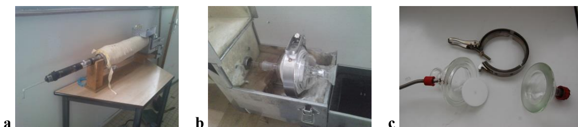
Figure 2-13 : Canne de prélèvement isocinétique (a), porte-filtre quartz (b) et porte-filtre démonté (c)
