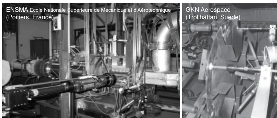
Figure 1. 42 : Banc de combustion employé par l'ENSMA et GKN Aerospace [187]
