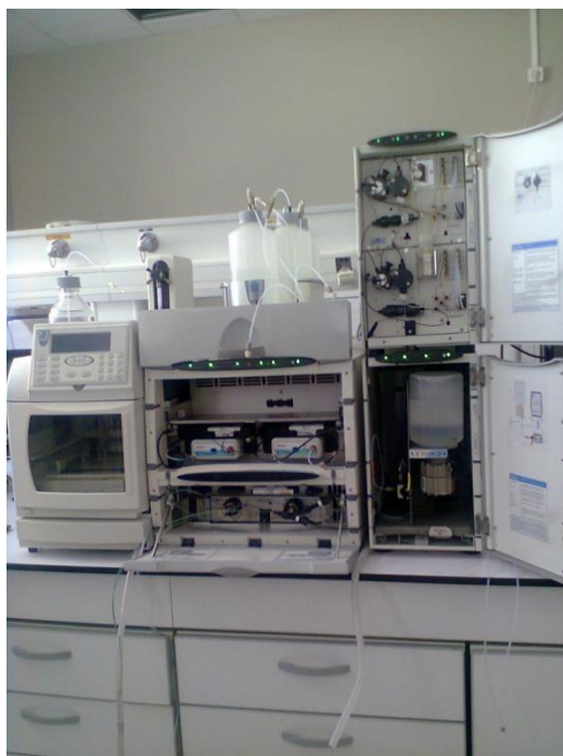
Figure II- 3: Photographie du système de chromatographie ionique DIONEX
