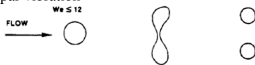
(a) Brisure par vibration
