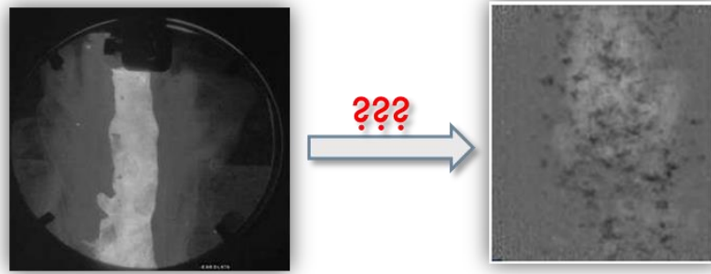
Figure 0-3 : Problème de la fragmentation du corium (passage d'une configuration de jet continu vers des gouttes et fragments). A gauche, photographie d'un jet de corium dans l'installation KROTOS, à droite visualisation du prémélange au rayon X dans la même installation.
