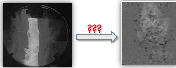
Figure 3-2 : Problème de la fragmentation du corium (passage d'une configuration de jet continu vers des gouttes et fragments)
