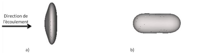
Figure 6-7 : Etats de déformation maximale de la goutte. a) déformation dans le sens perpendiculaire à l'écoulement (nappe). b) déformation dans le sens de l'écoulement (ligament)
