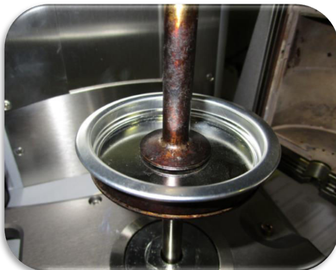
Figure 2.9 : montage plan-plan après mise en place de la coupelle dans laquelle sera positionné l'échantillon
