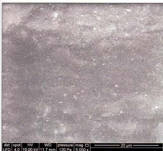
Fig. 5 : Clinpro Sealant® (taux de charges 5 à 10 % en masse ; MEB environnementale, grossissement X 5000) - Clinpro Sealant® (filler amount 5-10wt% ; ESEM, magnification X 5000).
