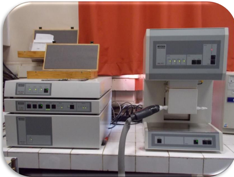
Figure 2.16 : dispositif de mesure par DMA (Institut Jean Lamour, Nancy)
