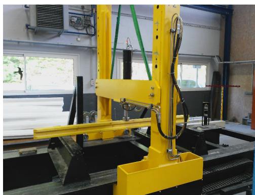
Figure 105. Flexion de la poutre en bois
