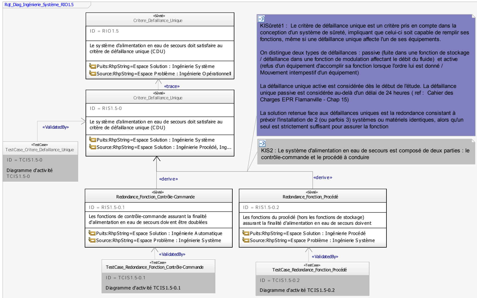
Figure 188 : Diagramme d'exigences SysML - Raffinement de l'exigence opérationnelle (RIO 1.5) par l'espace-solution d'ingénierie système
