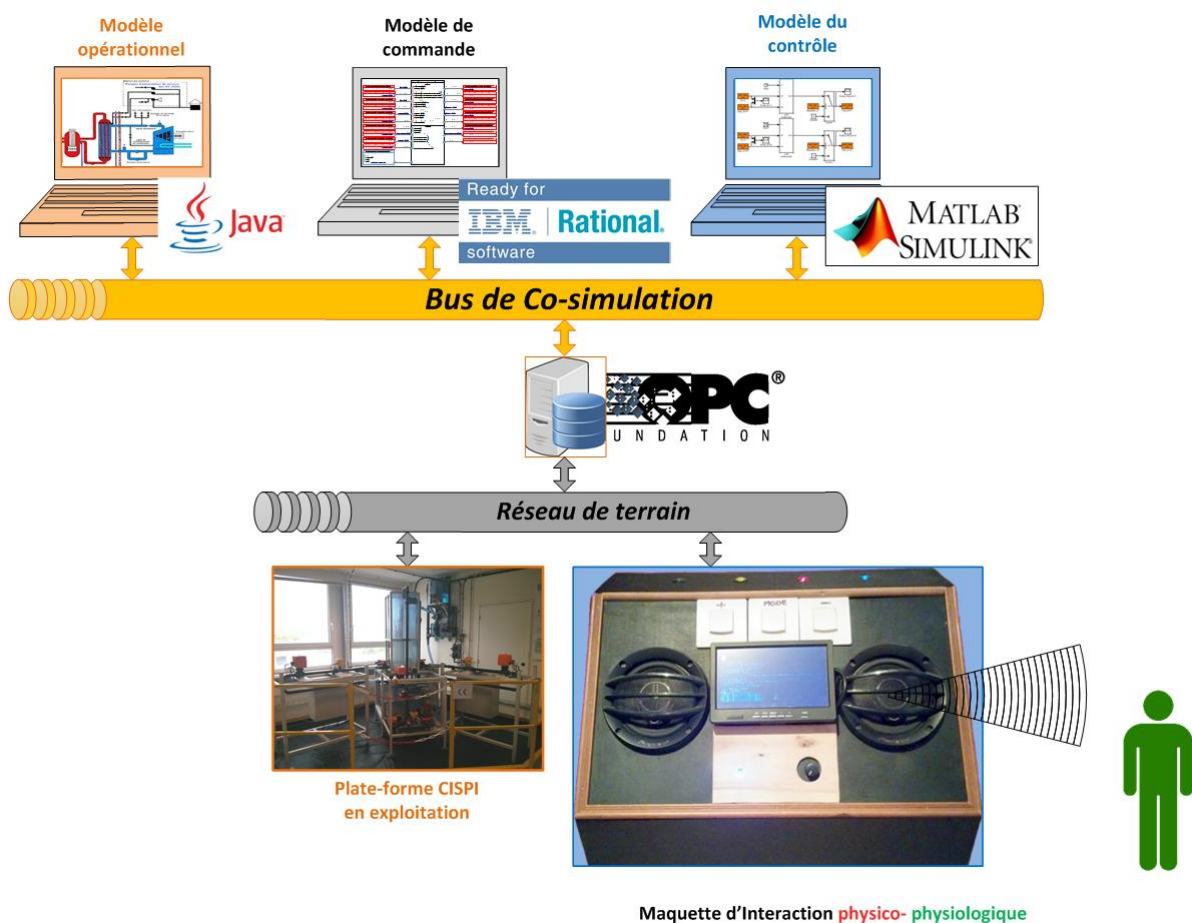
Figure 176 : Maquette physico-physiologique en interface avec la plate-forme CISPI
