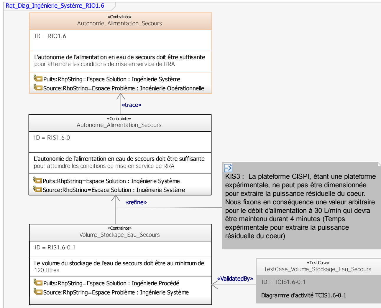
Figure 189 : Diagramme d'exigences SysML - Raffinement de l'exigence opérationnelle (RIO 1.6) par l'espace-solution d'ingénierie système
