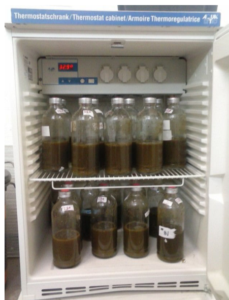
Figure II.1 : Tests BMP en incubation à 37 °C dans l'armoire thermorégulatrice
