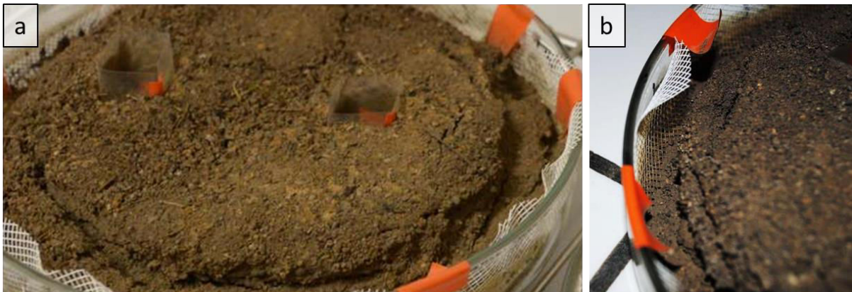
Figure VI-5 : Etat de surface des terres après vieillissement tempéré (Nancy - Cfb) (séquence tempéré – Nancy) : terre Ck4 (a) et terre Ck2 (b)
