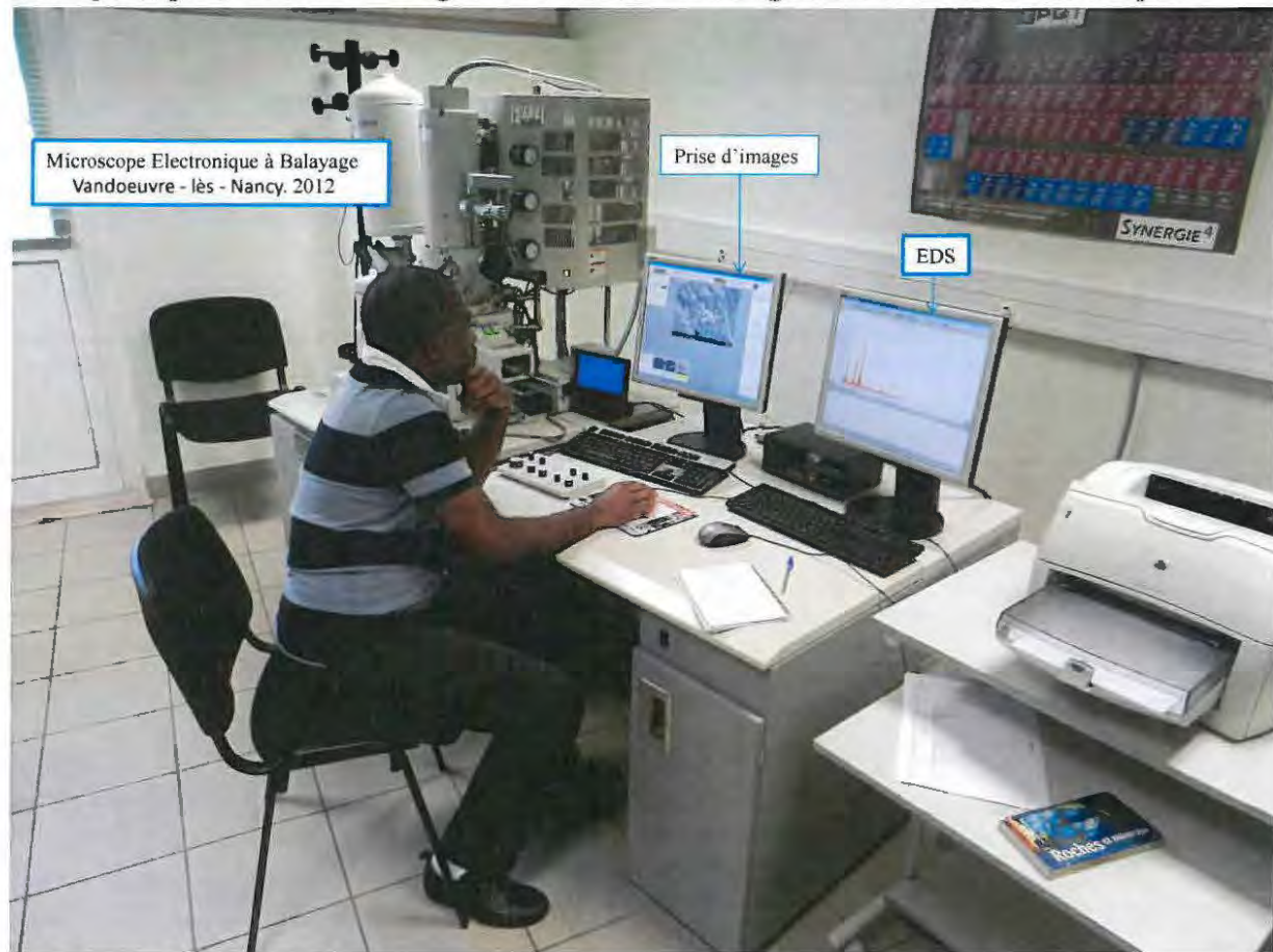
Figure III.2.3 : Microscope Electronique à Balayage moderne dans les locaux de l'UHP Vandœuvre-lès-Nancy 2012
