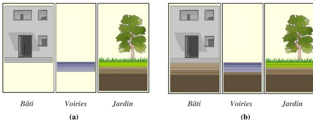
**Figure 71. Discrétisation du sol telle que prescrite par l'utilisateur pour la voirie est fonction du type de végétation pour les jardins (a) et telle qu'homogénéisée par le modèle (b)**
