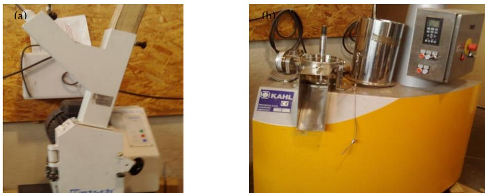
Photo 8 : broyeur (a) et presse à granulés (b)
