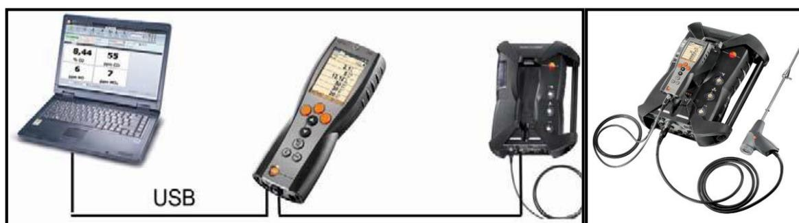
Figure 22 : Acquisition des données de l'analyseur via PC
