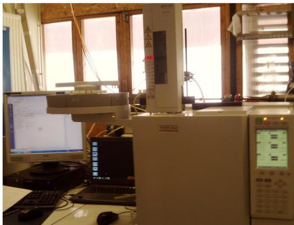
Photo 5 : système GC-FID GC-2010 Plus SHIMADZU
