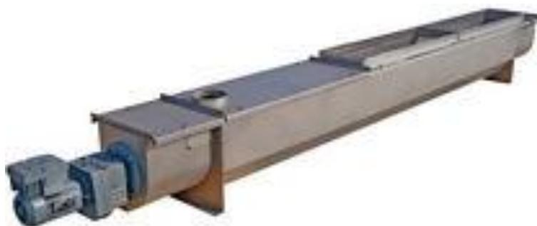
Photo 18 : Four de pyrolyse SPIRAJOLE
