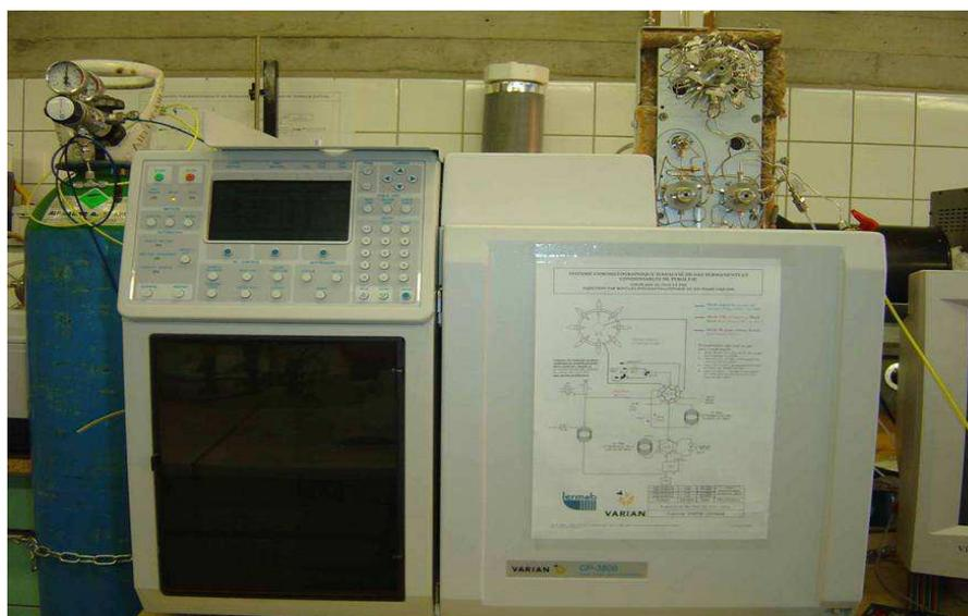
Photo 3 : Vue d'ensemble du système d'analyse chromatographique GC - TCD (CP-3800 ; VARIAN)
