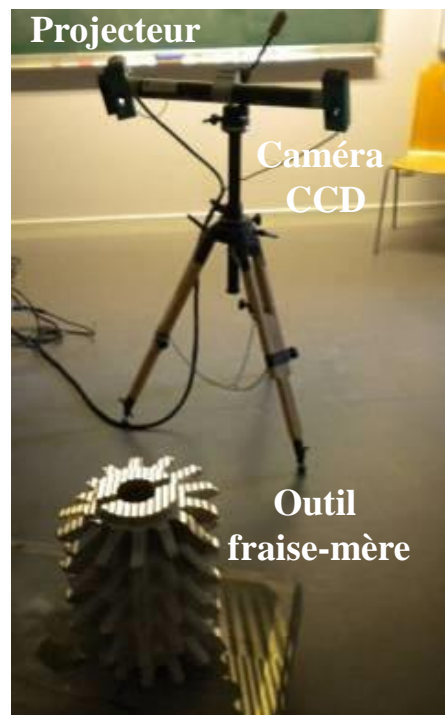
Figure 2.2. Numérisation de l'outil de coupe fraise mère par lumière structurée.
