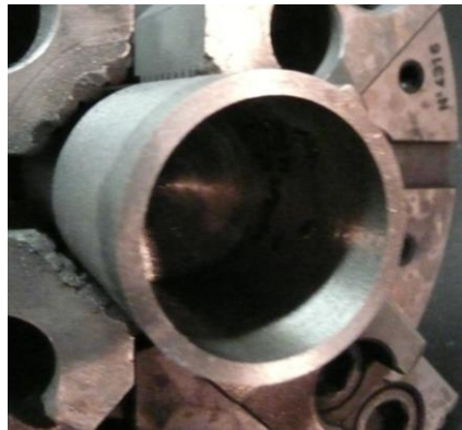
Figure 3.18. Echantillon préparé par usinage en forme de tube.
