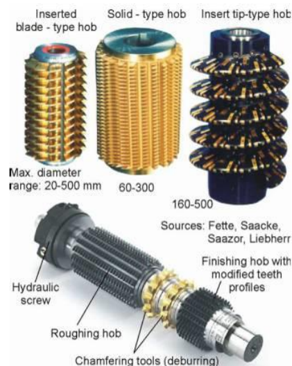
Figure 1.11. Illustration des variations géométriques de l'outil fraise-mère, [9].
