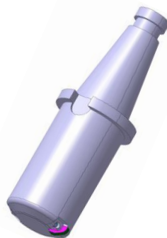
Figure 3.21. Porte-outil spécifiquement développé par le CIRTES, pour les essais expérimentaux de fraisage.
