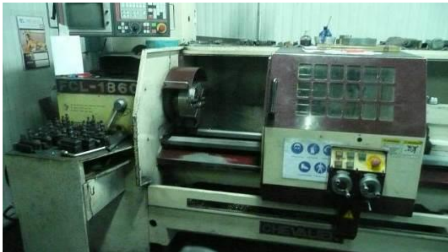
Figure 3.2. Centre d'usinage : Tour à commande numérique CHEVALIER.
