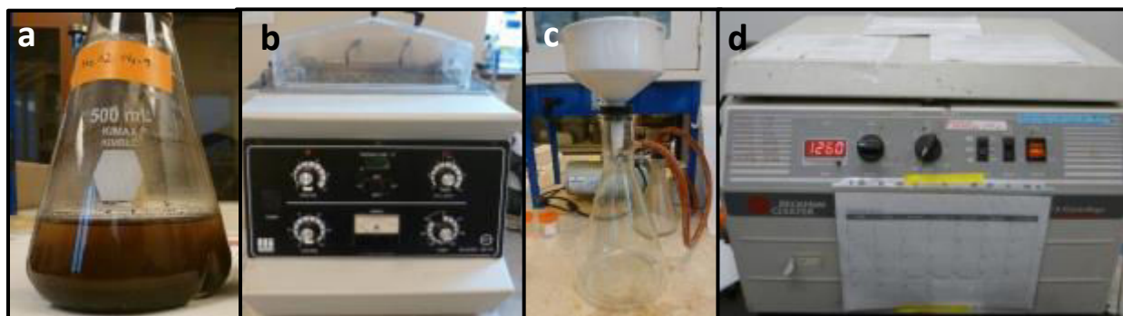
Figure 22 Photographie des équipements utilisés pour les tests du plan d'expérience, a. Erlenmeyer à chicanes de 500 mL, b. Agitateur avec bain-marie, c. Équipement de filtration, d. Centrifugeuse.
