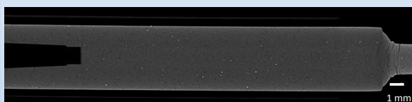
Figure 1 : Coupe tomographique de la seringue de XTE
