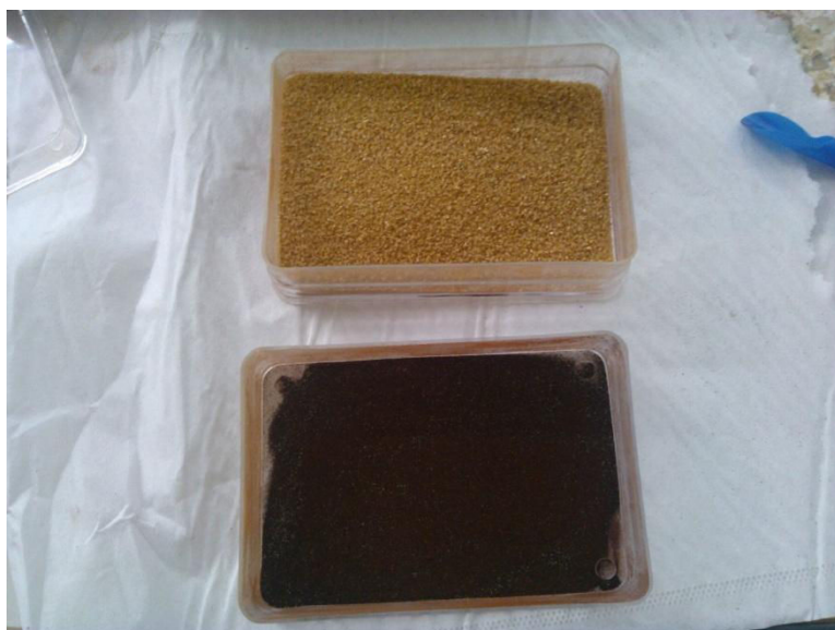
Figure 29 : Séparation du GEH® 104 du sable
