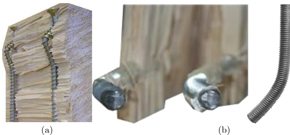
Figure III-90 : Conditions aux limites des vis [56] (a) et des tiges filetées [52] (b)
