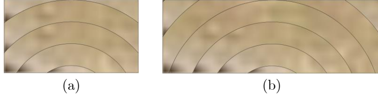
Figure II-66 : Type de lamelle ; (a) Faible épaisseur, (b) Epaisseur large
