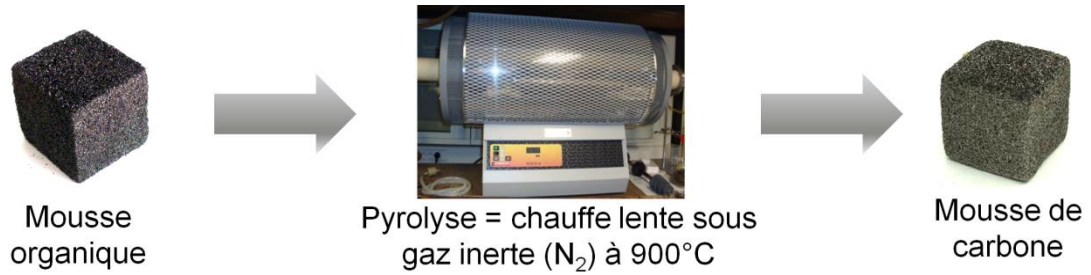
Figure 33 Transformation des mousses de tannin en mousses de carbone.
