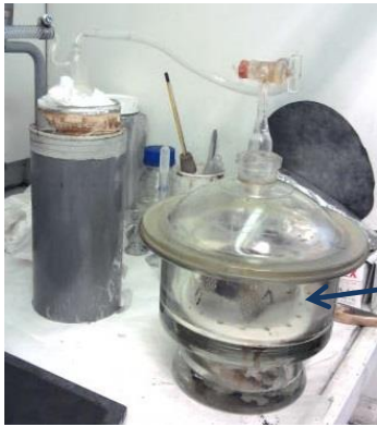
Figure 86 Imprégnation sous vide de mousses par une résine dérivée d'alcool furfurylique (ici étape de polymérisation dans HCl).
