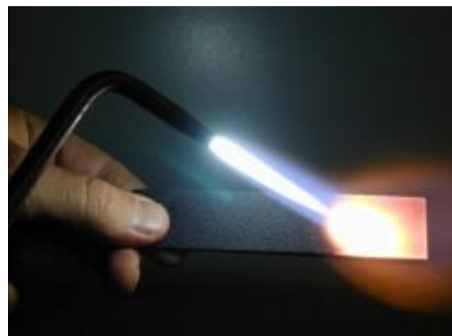
Figure 18 Test d'inflammabilité sur une mousse CFOAM [41].
