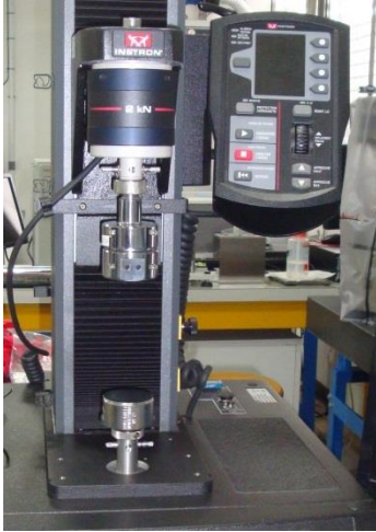
Figure 114 Machine d'essais universelle INSTRON 5944 équipée de ses plateaux de compression.
