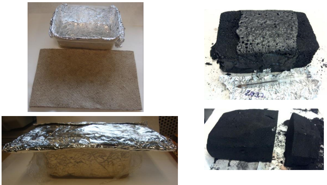
Figure 67 A gauche, moule dans lequel ont été produites toutes les mousses, et non-tissé servant à isoler la partie supérieure. A droite, mousse organique dérivée de tannin avant (en haut) et après (en bas) découpage de la couche externe non homogène.
