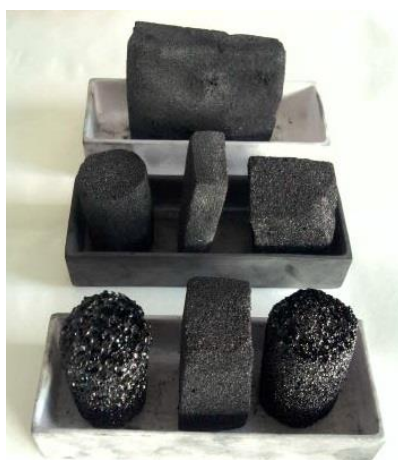
Figure 81 Echantillons de mousses de carbone dérivées de tannins juste après pyrolyse.
