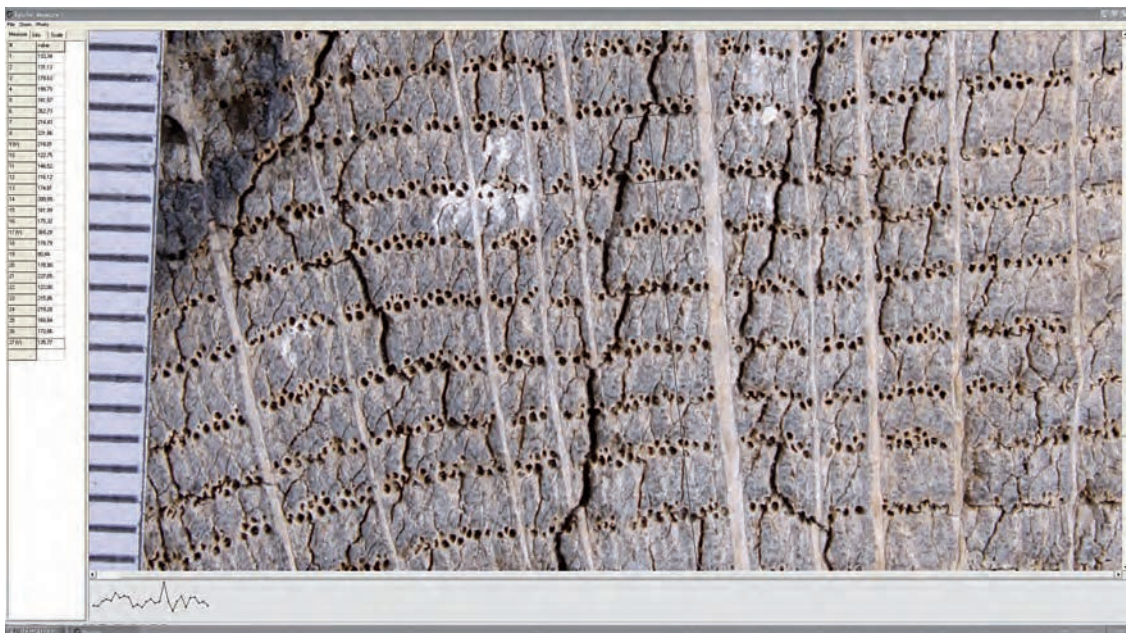
Figure 10 : Logiciel de mesure spécifiquement développé par notre laboratoire pour l'analyse des cernes de croissance des bois, à partir de clichés macrophotographiques ou de radiographies digitalisées (logiciel développé en 2002 par S. Meignier, D. Pousset et C. Locatelli)
