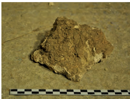
Fig. 235: Détail du mortier contenant des végétaux abondants
