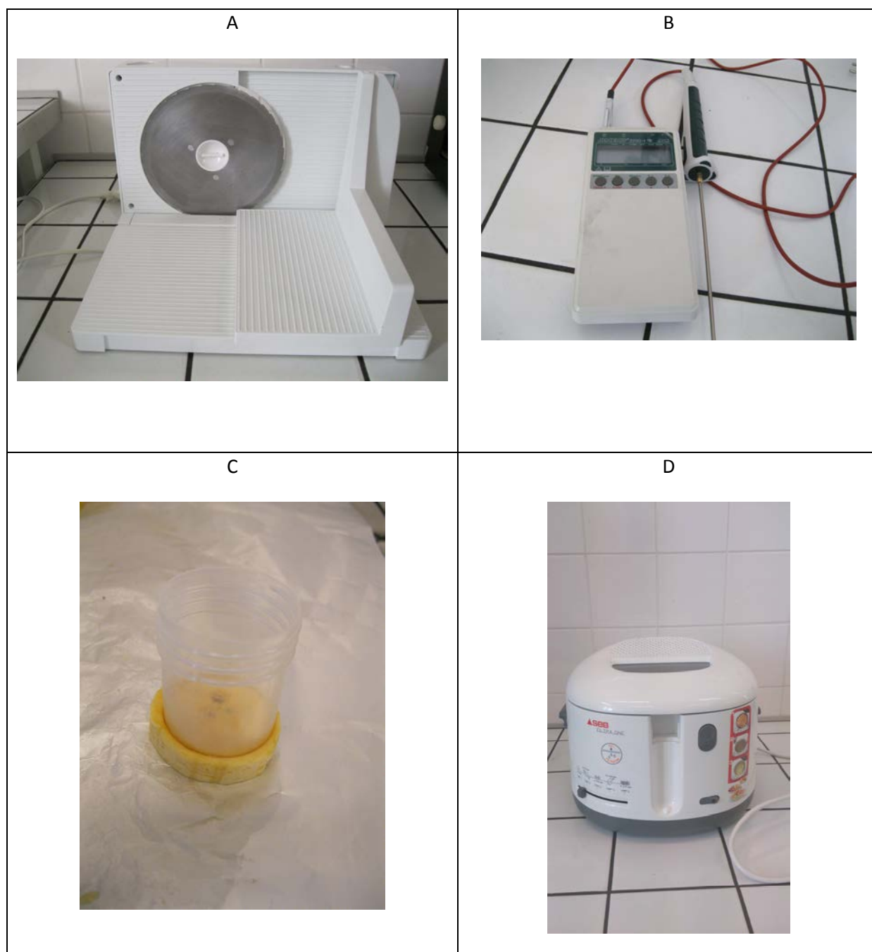
Figure 8-2 : Ensemble du matériel utilisé pour la préparation du plantain : trancheuse électrique SEB (A), enregistreur des données Almemo (B) ; emporte-pièce manuel (C) ; et friteuse ménagère électrique (D).
