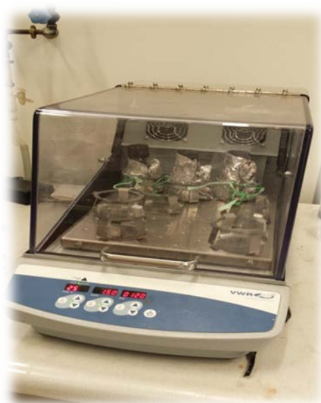
Fig. 26: Photo du réacteur adiabatique utilisé pour les essais d'adsorption du bleu de méthylène
