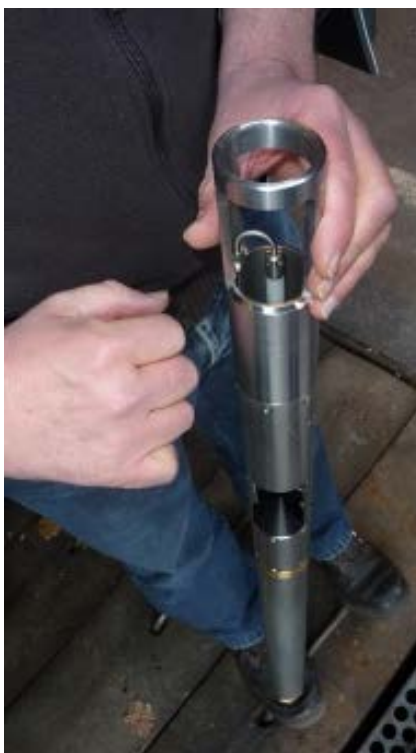
Figure 11 - Débitmètre heatflux utilisé pour la mesure de faibles vitesses dans le puits Vouters 2
