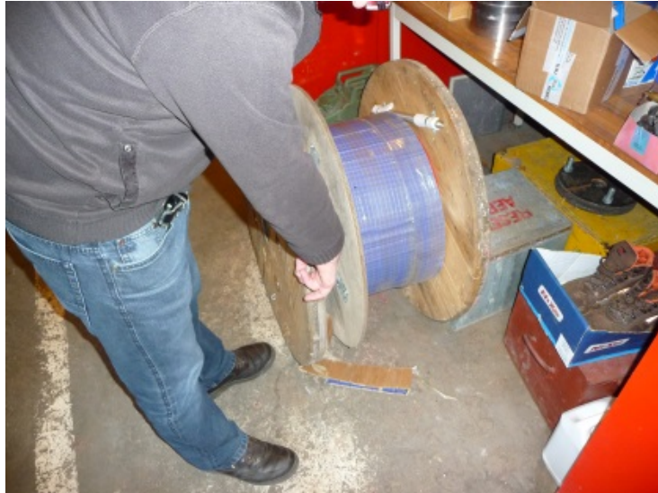
Figure 12 - Fibre optique utilisée dans le puits Vouters 2
