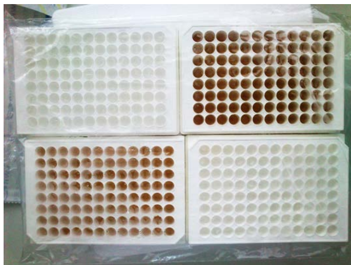
Figure 11: Gels de silice hybride matures conditionnés en atmosphère humide et stérile après autoclavage et synthèse automatisée (Robot Eppendorf epMotion 5070)
