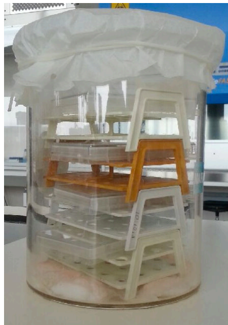
Figure 12 : Dispositif d'incubation en jarre des microplaques 96 puits
