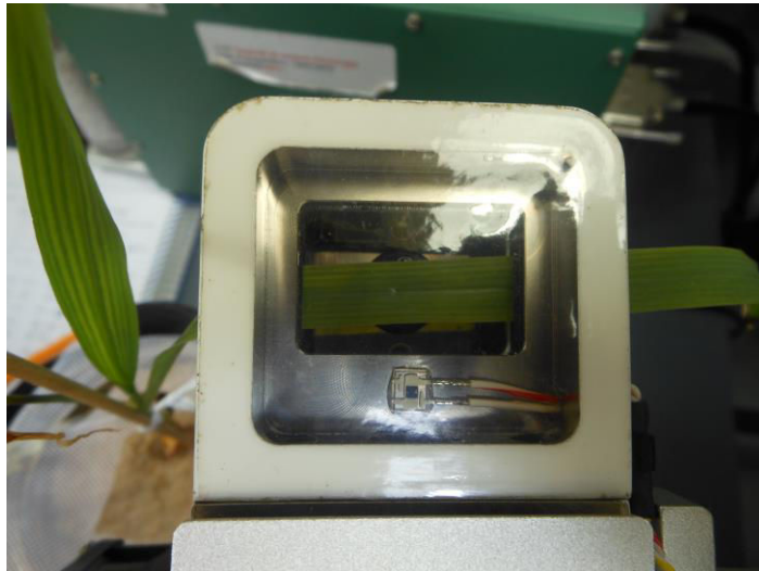
Figure 15 – Chambre de mesure des échanges gazeux d'un Li-Cor 6200
