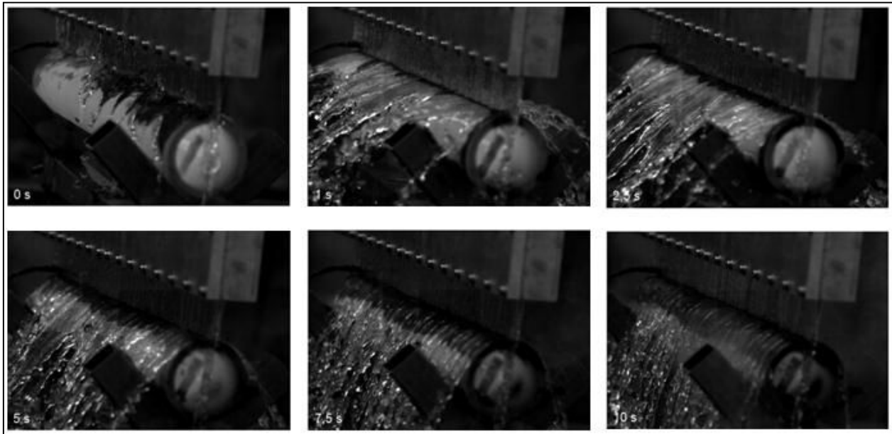
Fig. 4.10 Illustration des premières étapes du refroidissement
