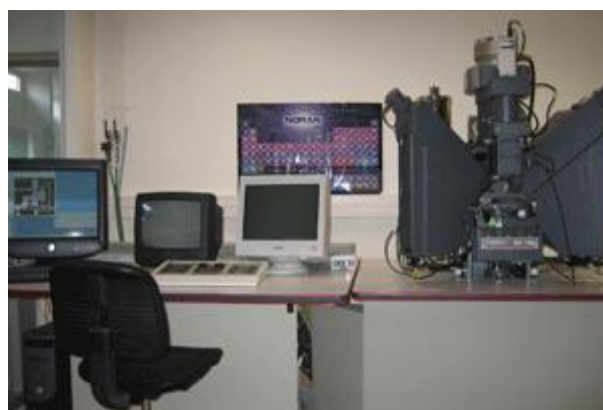
Figure I.3 : Microsonde électronique de Castaing Cameca SX100 (source SCMEM)
