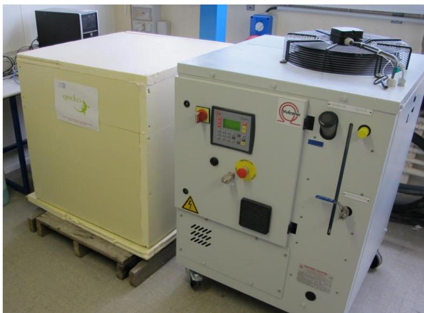
Figure IV.5. Cuve isolée et thermorégulateur.
