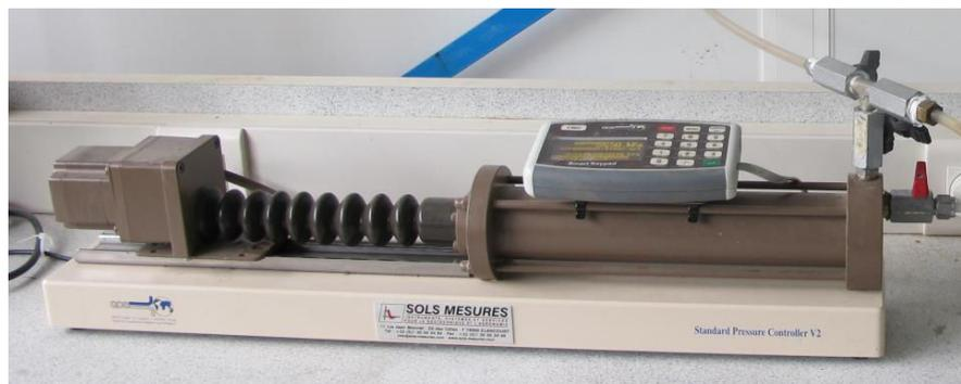
Figure IV.15. Contrôleur pression-volume (GDS Instruments®).
