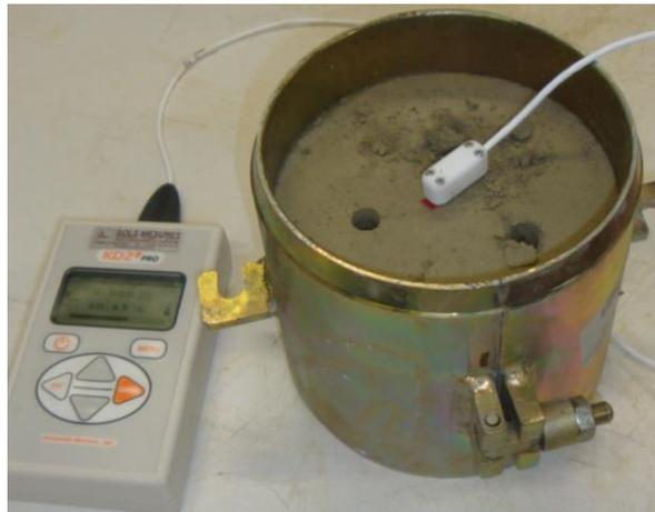
Figure V.17. Mesure des propriétés thermiques d'une éprouvette dans le moule CBR.
