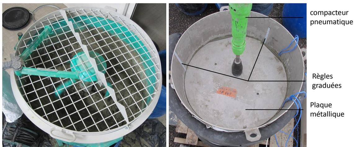
Figure IV.6. Préparation du matériau : (a) malaxage ; (b) compactage dans la cuve.
