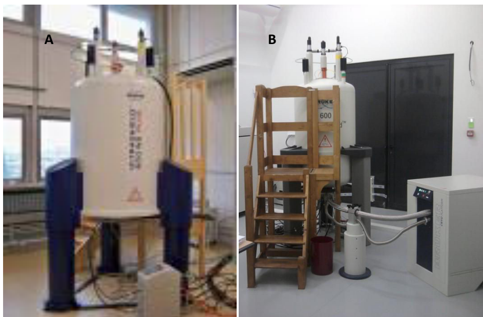
Figure II.5 : A) Bruker Avance III 600 MHz wide bore, spectromètre équipé pour la RMN haute résolution multi-noyaux, valeur du champ magnétique: 14.1T, fréquence de résonance du proton: 600 MHz, il se trouve dans le service commun de RMN de la faculté des sciences, et est géré par l'équipe de Méthodologie RMN (RMN) du laboratoire de cristallographie, Résonance Magnétique et Modélisations, UMR CNRS 7036.
