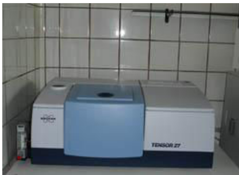
Figure II.8: L'appareil de spectroscopie Infrarouge de laboratoire LCPM
