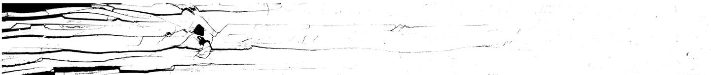
FIGURE 3.13: Mise en évidence des fissures par binarisation
