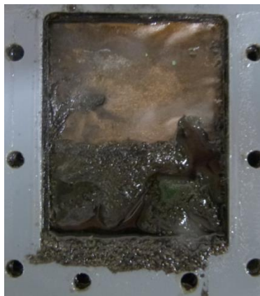
Figure 89 : photographie de la membrane cationique à la fin de l'expérience
