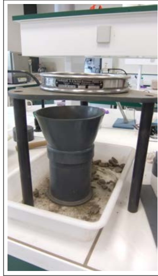
FIGURE A.1 – Dispositif de mesure de la densité apparente en application à la norme NF - EN 12580
