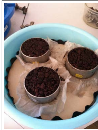
FIGURE B.3 – Les cylindres contenant le substrat des toitures végétalisées posées sur une plaque poreuse en porcelaine
