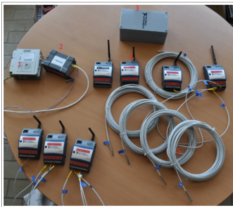
FIGURE C.2 – Photographie de l'ensemble ; sondes de température et système d'acquisition pour la toiture du LRN : 1 : Alimentation pour NI WSN 3791, 2 : NI WSN 3791 Ethernet Gateway, 3 : NI WSN 3291, Protection extérieure de NI WSN 3226, 4 : NI WSN 3226 Nodes, 5 : Thermo-Est Sondes PT100
