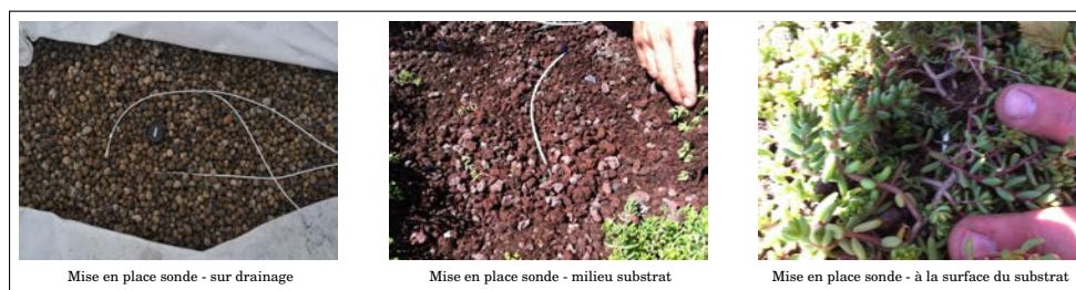
FIGURE C.3 – Photographie de la mise en place des sondes de température pour la toiture du LRN : à gauche entre le géotextile et le drainage de la parcelle (AE), au milieu : mise en place de la sonde dans la couche de substrat, à 7 cm de profondeur par rapport à la surface de la parcelle (S60). À droite : mise en place de la sonde à la surface du substrat, au niveau de la canopée
