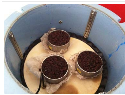
FIGURE B.2 – Les cylindres contenant le substrat à l'intérieur des presses extractives
