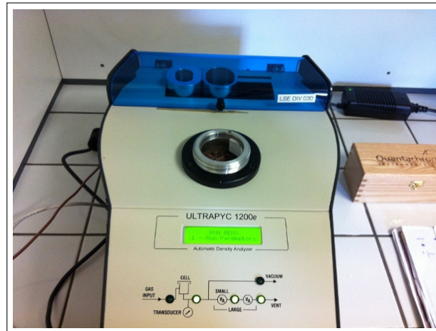
FIGURE 3.5 – Dispositif de mesure de la densité réelle par la méthode du pycnomètre à He
