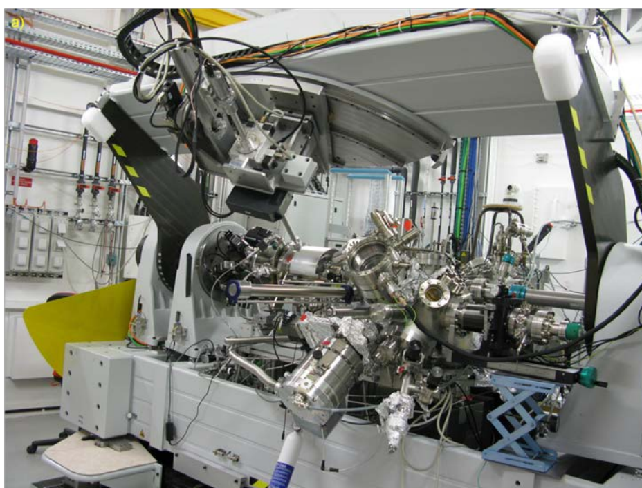
Figure 49 : Diffractionmètre de la ligne SIXS du synchrotron SOLEIL couplé à une chambre ultra-vide où les mesures de diffraction ont été réalisées.
