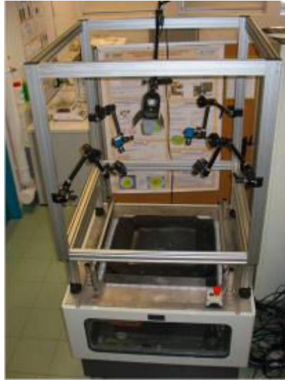
Figure 1.3 : Banc multi-caméras et pilote SPIF [Dec09]
