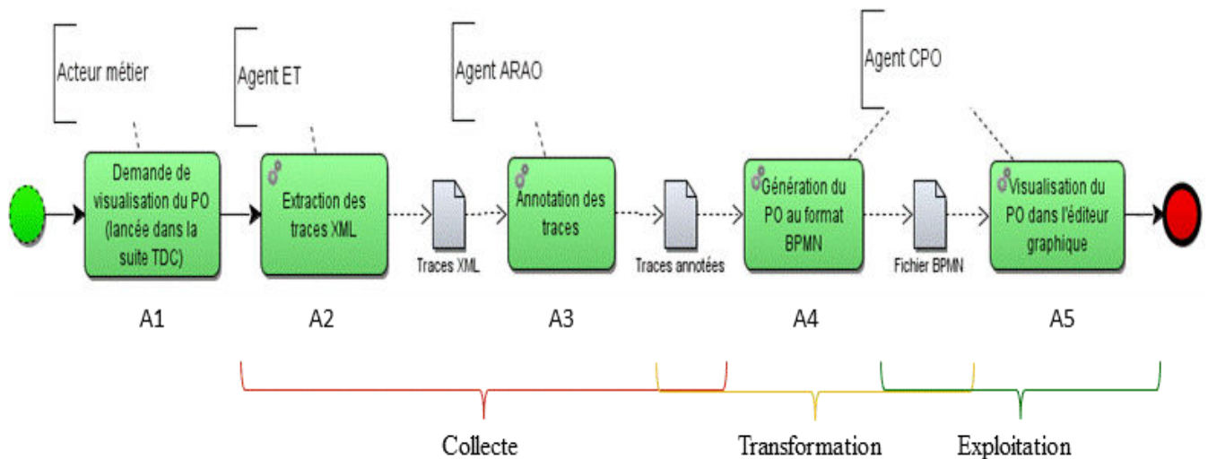
Figure 52. Structure fonctionnelle du Système à Base de Traces
