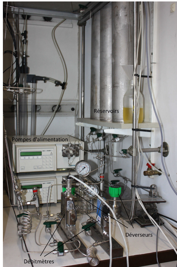
Figure 3.3 – Photographie rapprochée du bloc d'alimentation du pilote.
