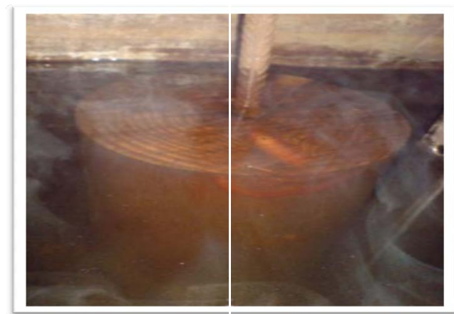
Figure III 9: Billon immergé à 50°C maintenu sous l'eau à l'aide d'une barre métallique
