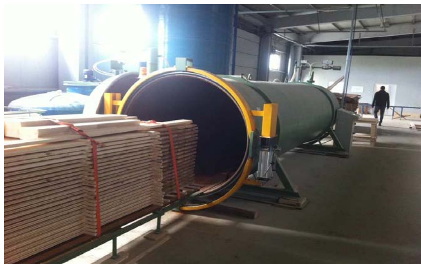
Figure I 36. Imprégnation par autoclave ( http://www.rolam.ro/fr/traitement-et-impregnation-du-bois )
