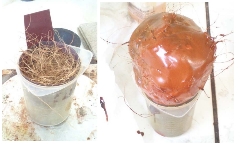
Figure 36: Essai d'injection de résine moussante (formulation n°4) par dessus un mat de fibres de coco cardé dont on a enlevé le ficelage; les fibres ont été entraînées par l'expansion de la mousse et s'y sont entremêlé de façon plus ou moins homogène.
