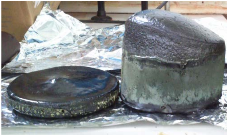
Figure 23: La mousse de gauche contient un peu plus d'eau dans sa formulation par rapport à la mousse de droite, ce qui a absorbé la chaleur nécessaire à l'évaporation de l'agent moussant. Celui-ci s'est en partie évaporé, et a formé de gros trous à la base, pris au piège, lorsque la résine a finit par solidifier, d'abord par le haut qui était à l'air libre, créant ainsi une peau épaisse et dense sur le dessus du matériau.
