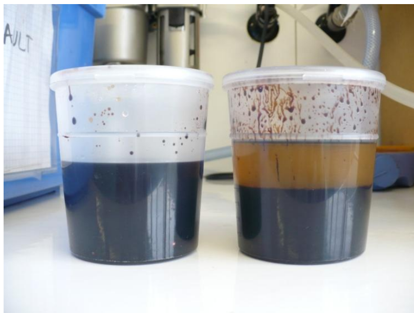
Figure 36 : Deux expériences différentes de mélange huile ozonée/ tannins : à gauche, on obtient une résine homogène, et à droite le mélange est composé de deux phases distincte.
