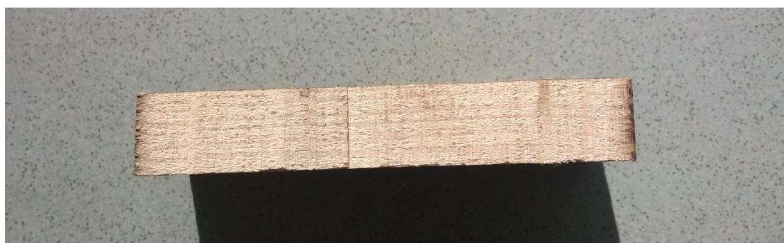
Figure 30: Coupe transversale de la pièce d'épicéa imprégnée.
