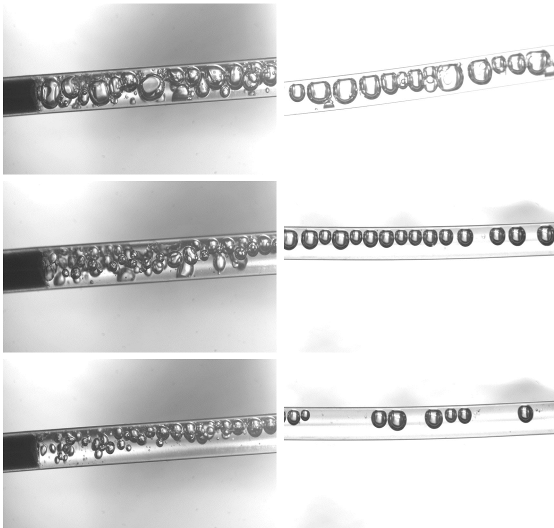
FIGURE 7.9 – Images de la dispersion gaz-liquide à la sortie du micro-mélangeur (à gauche) et à la fin du tube d'observation (à droite), pour un débit de gaz de Q_G = 50 mL/min et des débits de liquide de Q_L = 20 mL/min (en haut), Q_L = 40 mL/min (au milieu) et Q_L = 60 mL/min (en bas).
