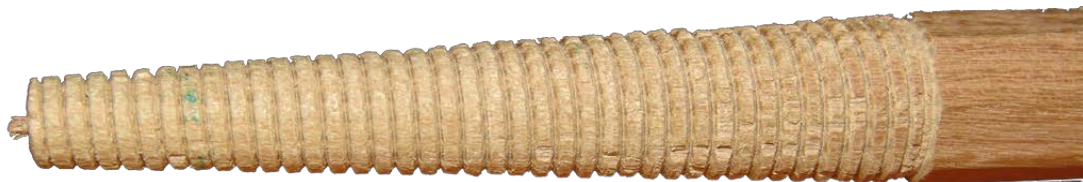
FIGURE 8.2 – Vis usinée sur un mini-tour à commande numérique
