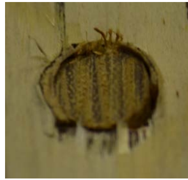
(b) Rupture du filet en cisaillement
