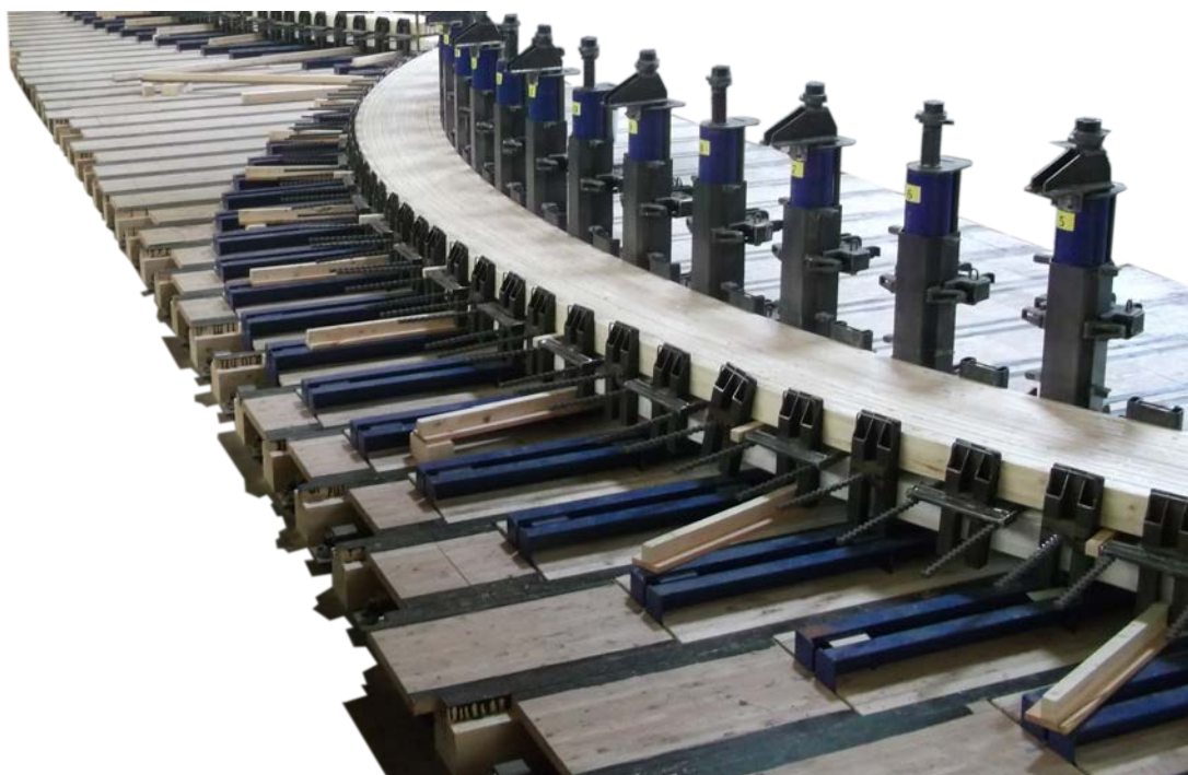
FIGURE 1.3 – Banc de pression semi-automatique déployé chez Fargeot Lamellé Collé
