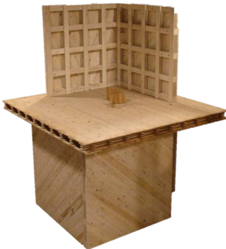
FIGURE 1.13 – Parois assemblées par tourillons soudés
