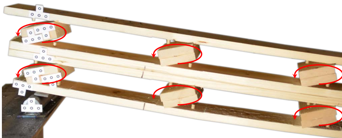
FIGURE 10.6 – Rupture en arrachement des vis bois
