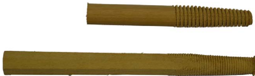
FIGURE 8.3 – Illustration du problème de fabrication des vis
