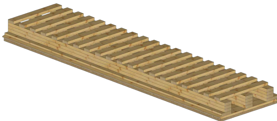
FIGURE 10.1 – Exemple de module de dalle reconstituée en éléments bois
