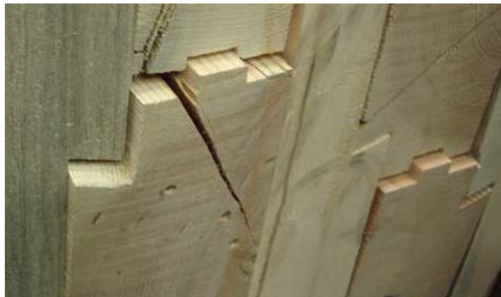
FIGURE 1.11 – Rupture par glissement des pièces
