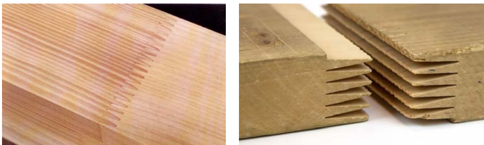
Figure 1.3 – Aboutage par entures multiples.
