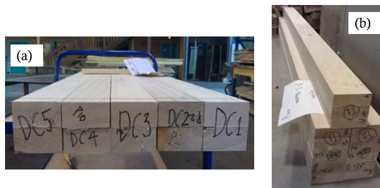
Figure 3.6 – Poutres multicouches fabriquées, (a) DUO, (b) TRIO.
