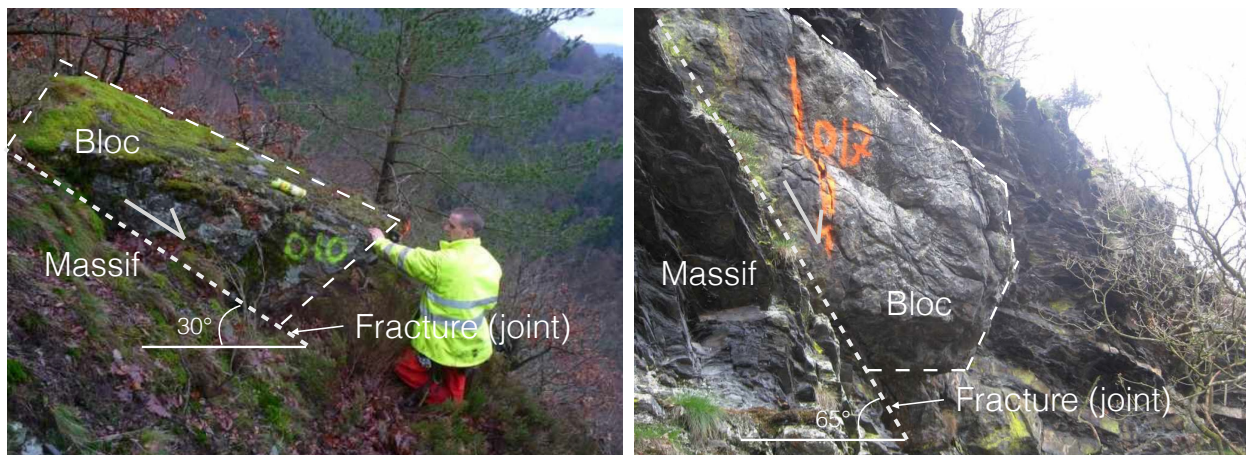
Figure 39. Cas réels de glissements plans avec des pentes inférieures et supérieures à 50^\circ .
