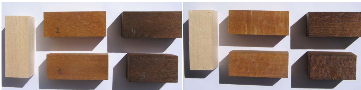
Figure 151 : Photographies des faces tangentielle (gauche) et radiales (droite) d'échantillons de hêtre non traité (gauche) et des composites issus des traitements dans le CO 2 supercritique à 25% (milieu) et à 50% (droite)
