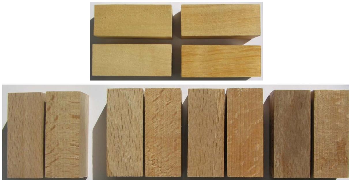
Figure 86 : Photographies de l'aspect des échantillons de peuplier (en haut) et de hêtre (en bas) ; sur chaque photographie, les deux échantillons de gauche sont bruts, ceux de droite sont traités ; pour le hêtre, chaque paire d'échantillons correspond à un traitement (1, 2 puis 3 de gauche à droite)
