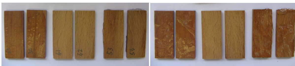
Figure 124 : Photographies des composites à base de MATRIFE ; à gauche : face supérieure, à droite : face inférieure, et de gauche à droite : MATRIFE pur (29, 30), MATRIFE / acétone (41, 42) et émulsion de MATRIFE (53, 54)
