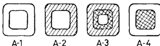
Figure 34 : Modèle pour la modification chimique du bois à l'échelle cellulaire ; A1 : non traité ; A2 : paroi cellulaire imprégnée sans dépôt dans le lumen ; A3 : paroi cellulaire imprégnée avec dépôt à la surface du lumen ; A4 : lumen rempli de produit, mais paroi cellulaire non imprégnée (79)
