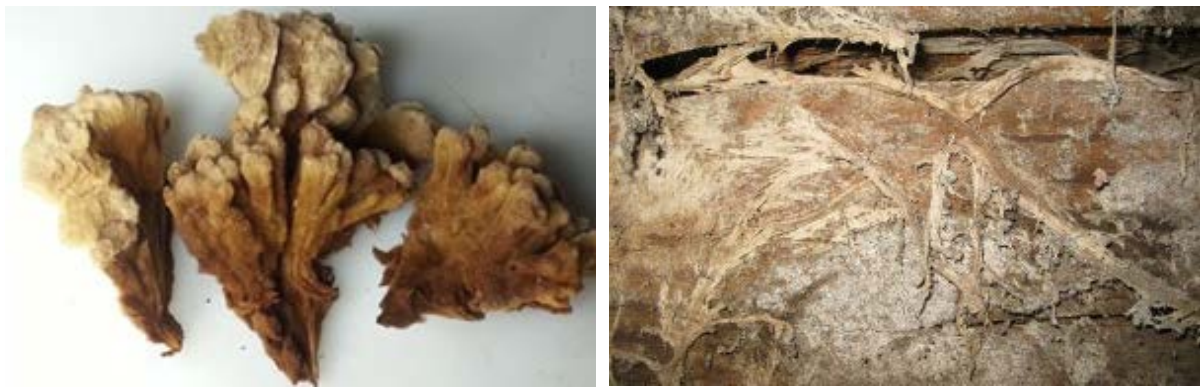
Figure 13 : Xylostromes de polypore des caves ( Donkioporia expansa ), à gauche (17) ; rhizomorphes de mérule ( Serpula lacrymans ), à droite (18)
