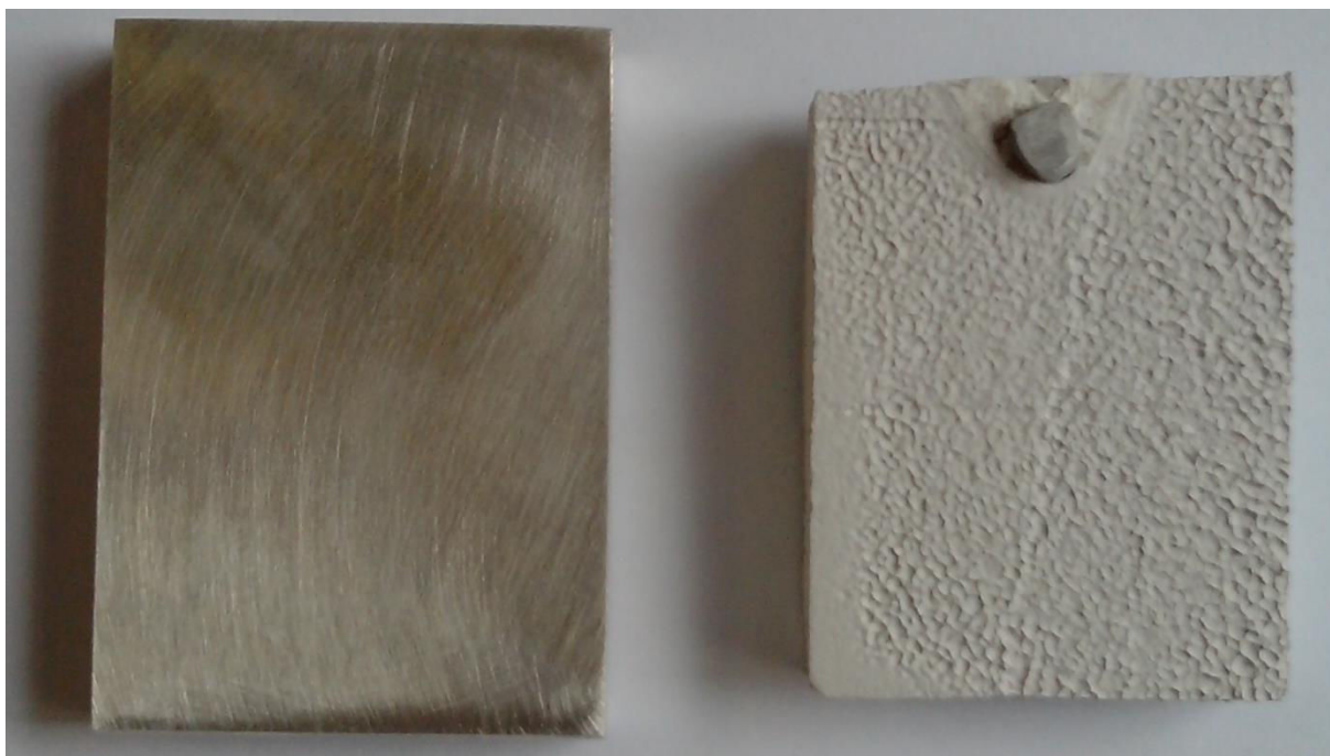
Figure V-12 : Photographie d'un échantillon avant traitement (gauche) et d'un échantillon après un traitement de 40 minutes dans un électrolyte composé de 10 \text{ g.L}^{-1} de \text{NH}_4\text{F} (droite).
