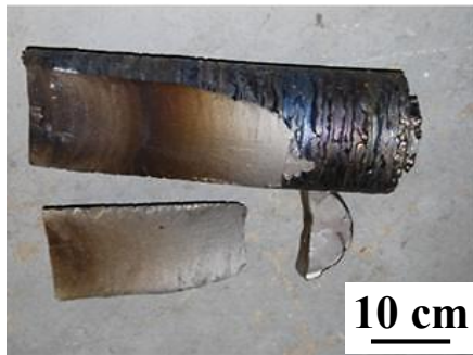
Figure II-1 : Macrographie du lingot de 150 mm de diamètre pesant 50 kg élaboré par fusion à l'arc d'éléments purs
