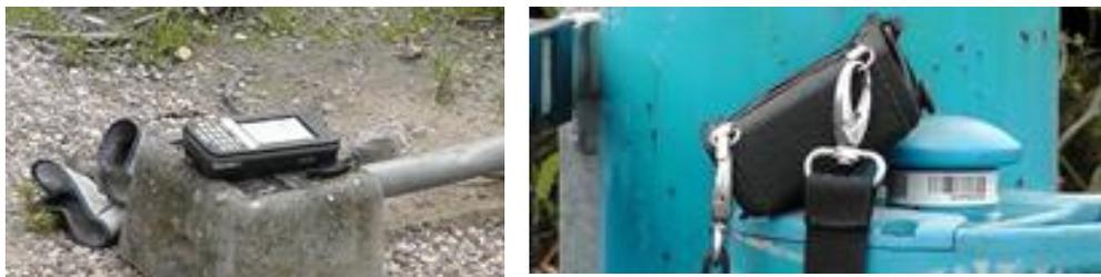
Figure 47. Equipements introduits dans le cadre de la mise en place du système de traçabilité : lecteur de code-barre (handheld) et imprimante.
