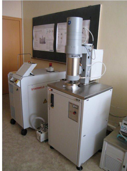
III-17 : Photographie du dispositif LFA 427 (Netzsch) utilisé à l'IJL-Nancy.
