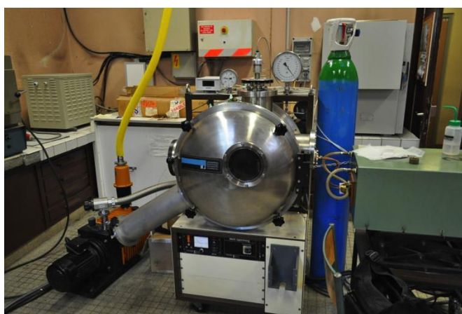
Figure III-4 : Dispositif de trempe sur roue présent à Nancy.
