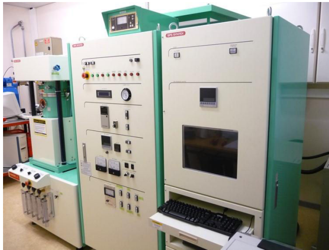
Figure III-8 : SPS Dr Sinter 515S de SPS Syntex Inc. installé à l'IJL.
