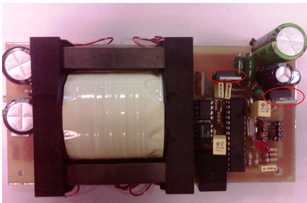
FIGURE A.5 – La photo convertisseur DC-DC MCB-RS auto-alimenté dedans circle rouge.
