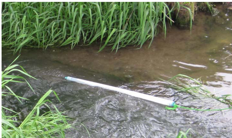
Figure II.8 : bailer lancé pour prélever un échantillon.
