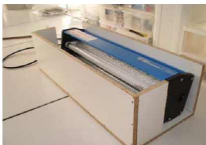
Figure II.13 : lampe UV utilisée pour les irradiations.
