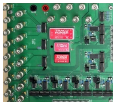
Figure 2-36 : Carte d'interface placée entre le convertisseur à IGBT et la carte FPGA.
