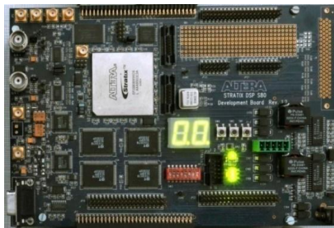
Figure 2-35 : Photographie de la carte de développement FPGA (composant Stratix S80B956C6).
